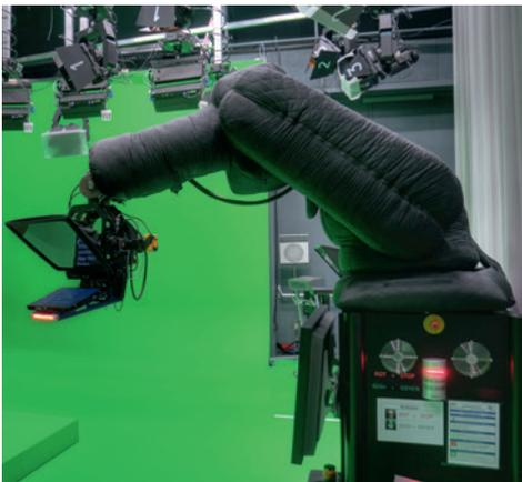
der Camerobot-Datenbank verfügbaren Aufnahmen und Bewegungen. Der Bediener wählt oder markiert in OpenMedia die Aufnahmen und Bewegungen, die bei der Sendung verwendet werden sollen.
